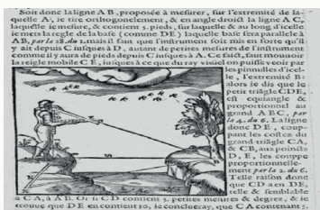
Figura 14. Página del libro de Errard con el instrumento para medir distancias inaccesibles
